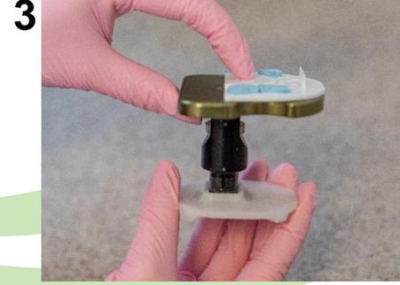
Coloque la bandeja de registro dentro de la plataforma en los huecos de la bandeja, asegurándose que la bandeja este plana en la plataforma.
