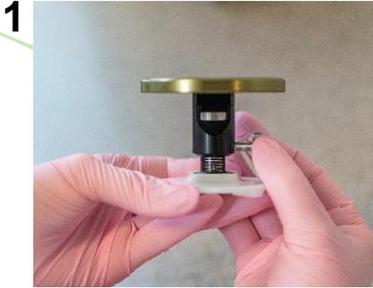
Desbloquee la plataforma con el tornillo de seguro, usando el tornillo dactilar gire para poner la plataforma en cero y entonces asegure en su lugar con el tornillo de seguro.
